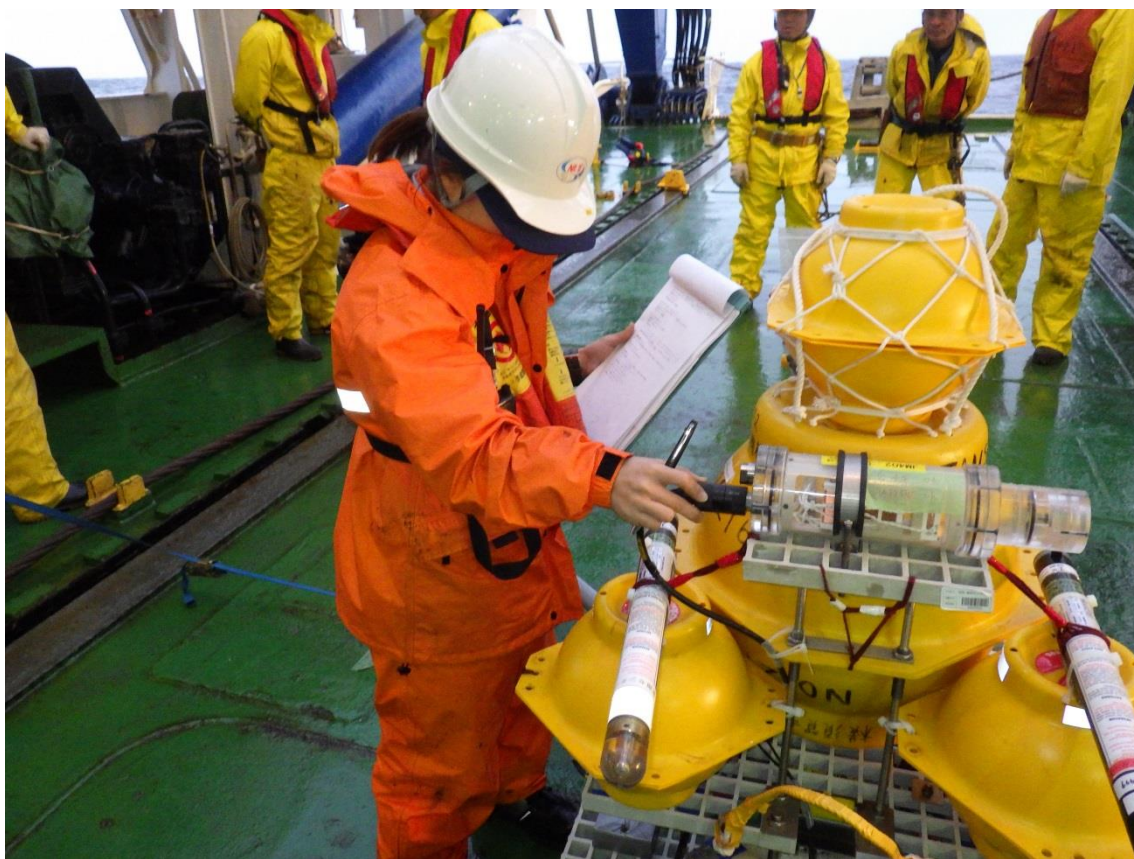
「よこすか」船上でOBEM（海底電位差磁力計）投入前の最終確認
